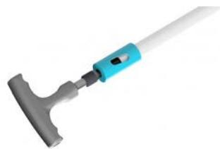
Das Rohr bis zum Anschlag mit dem Kunststoffring an der Schlauchtülle des Anschlusses montieren. Das Rohr ist dann korrekt montiert, wenn es durch alle Inspektionsfenster des Kunststoffrings zu sehen ist.
