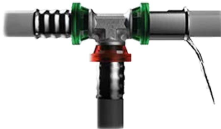
Das LEAK BEFORE PRESS-System garantiert eine schnelle und sichere Installation der Pressfittings, da Flüssigkeit austreten kann, wenn die Verbindung nicht abgepresst wurde.
