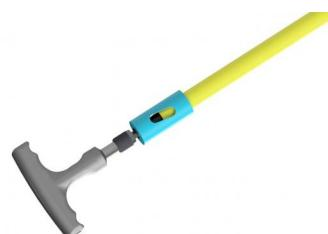
Das Rohr bis zum Anschlag mit dem Kunststoffring an der Schlauchtülle des Anschlusses montieren. Das Rohr ist dann korrekt montiert, wenn es durch alle Inspektionsfenster des Kunststoffrings sichtbar ist
