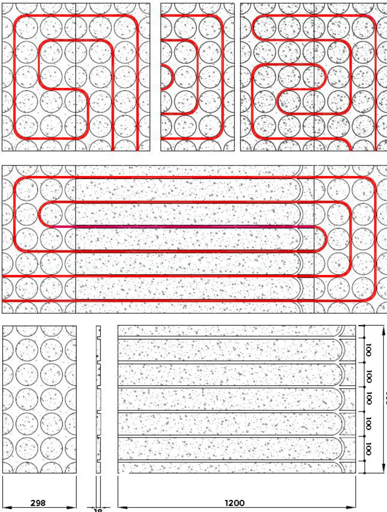
Los paneles VARMO DRY se fabrican en diferentes versiones: la más grande se utiliza donde la tubería tiene
