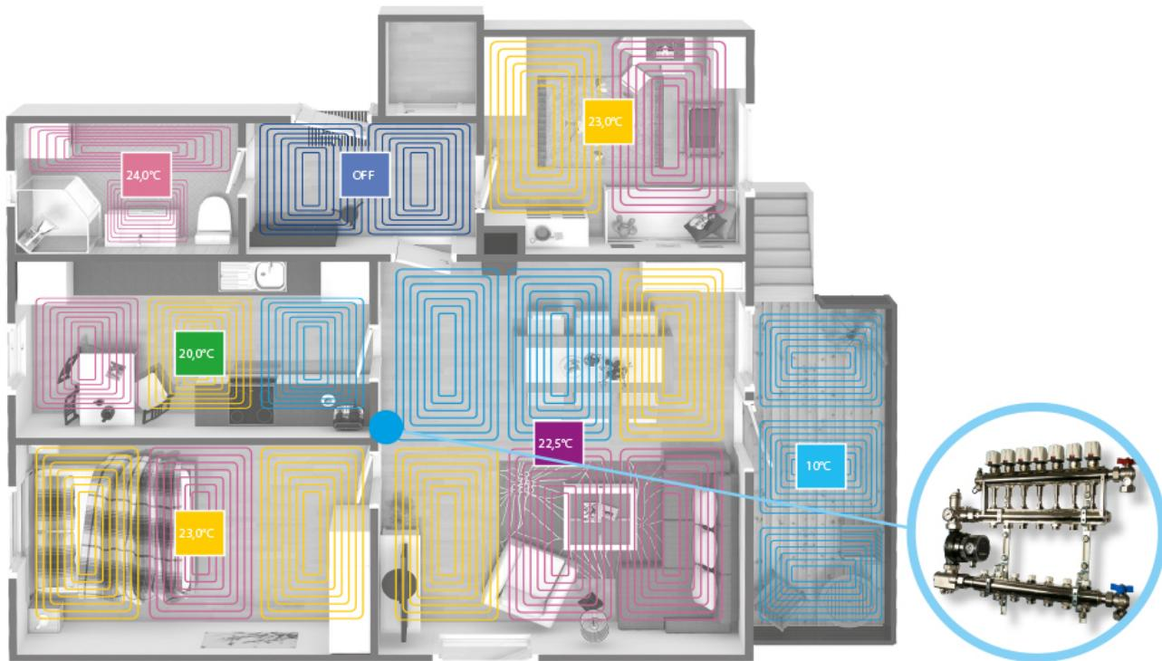
Grâce à ses caractéristiques particulières, l'unité de contrôle Tritone permet de réguler facilement et immédiatement les températures dans différentes pièces, ce qui permet d'éviter la distinction entre les pièces "défavorisées" et les pièces "favorisées".
