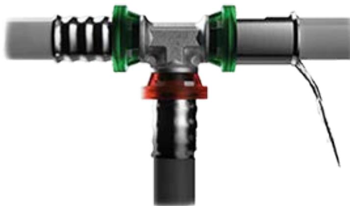
Система LEAK BEFORE PRESS гарантирует быстрый и надёжный монтаж пресс-фитингов, так как позволяет обнаружить утечку жидкости в точках недостаточного обжима.
