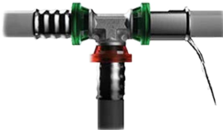
Le système LEAK BEFORE PRESS garantit une installation rapide et sûre des raccords à sertir car il permet l'écoulement de liquide là où la jonction n'a pas été sertie.
