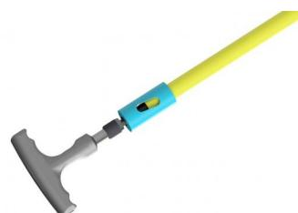
Calzare il tubo sul portatubo del raccordo fino a battuta con l'anello plastico. Il tubo è inserito correttamente quando è visibile attraverso tutte le finestre di ispezione della ghiera di plastica
