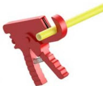
Откалибруйте трубу с помощью подходящей развёртки (код CS50.00, MA00.90), удалив оставшуюся стружку. Край трубы должен быть обрезан по всей окружности.
