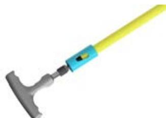
Placez le tube sur le support du raccord jusqu'à ce qu'il soit en butée contre l'anneau en plastique. Le tube est correctement inséré lorsqu'il est visible à travers toutes les fenêtres d'inspection de l'écrou à bague en plastique
