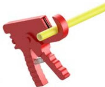
Étalonnez et ébavurez le tube avec la jauge appropriée [code CS50.00 ; MA00.90], en prenant soin d'enlever les éventuels copeaux résiduels. Le chanfreinage interne doit être réalisé sur toute la circonférence.
