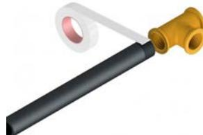
Vérifiez qu'il n'y a pas d'excès de matière ajoutée pour éviter une éventuelle rupture due à un serrage excessif.
