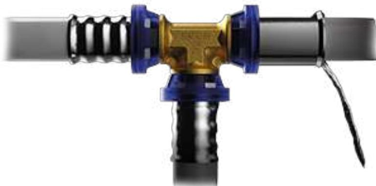
Le système LBP assure une installation rapide et sûre des raccords à sertir car il permet au liquide de s'échapper là où le joint n'a pas été pressé.
