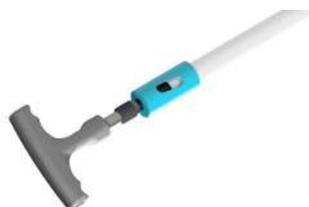
Placez le tube sur le support du raccord jusqu'à ce qu'il soit en butée contre l'anneau en plastique. Le tube est correctement inséré lorsqu'il est visible à travers toutes les fenêtres d'inspection de l'écrou à bague en plastique.
