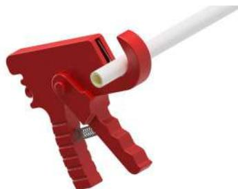
Étalonnez et ébavurez le tube avec la jauge appropriée [code CS50.00 ; MA00.90], en prenant soin d'enlever les éventuels copeaux résiduels. Le chanfreinage interne doit être réalisé sur toute la circonférence.
