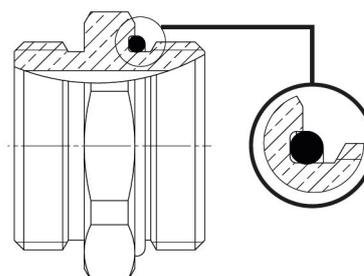
Visser les raccords au collecteur secondaire en utilisant la partie filetée avec joint torique.
