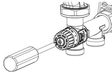
4. Tourner lentement la poignée, par étape, dans le sens inverse des aiguilles d'une montre vers les températures croissantes et toujours attendre que la température se stabilise en contrôlant sur le thermomètre d'alimentation. Continuer jusqu'à atteindre la température d'alimentation de l'eau mélangée souhaitée.
