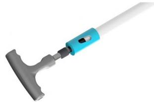
Calzare il tubo sul portatubo del raccordo fino a battuta con l'anello plastico. Il tubo è inserito correttamente quando è visibile attraverso tutte le finestre di ispezione della ghiera di plastica.
