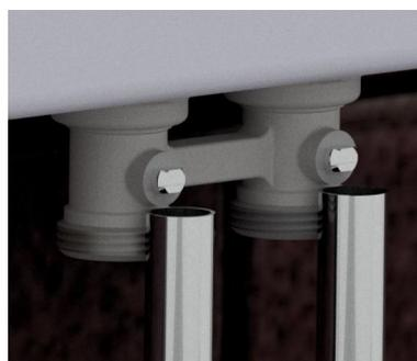
Вставить соединительные комплекты 5700H4N051500A (для медной трубы) или 7E00H4N051500A (для трубы из меди / стали) на трубы и угловые соединения для радиаторов 3400.K2.1 в гнезда евроконуса Н-образного клапана.
