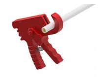
Calibrar y desbarbar el tubo con el calibrador indicado [código CS50.00; MA00.90], prestando atención a eliminar cualquier residuo posible.
