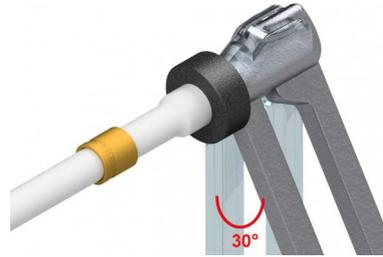
Corte los tubos que no presenten una circunferencia regular luego de la expansión del mismo y descarte la sección del tubo que no sea conforme. Sustituya los expansores que estén dañados o que no permitan obtener una circunferencia perfecta del tubo ensanchado. Un expansor defectuoso puede causar problemas de sujeción en el tiempo.
