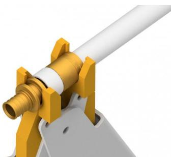
AUTOMÁTICA: Empuje el buje hacia el racor. Colocar los elementos entre las mordazas de la máquina de prensado, prestando atención a que el buje y el cuello del racor estén correctamente situados respecto a la mordaza.
