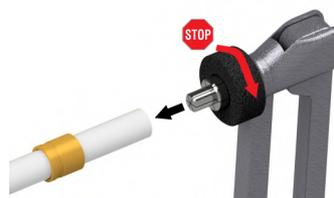
Insertar el buje en el tubo, verificando que el marcado este del lado opuesto al corte del tubo y que entre el final del tubo y el buje exista una distancia equivalente al doble del largo de esta última.
