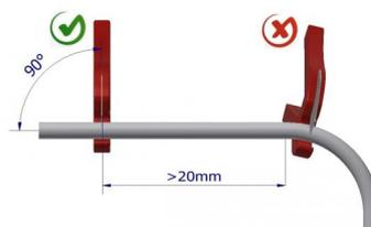
Verificar que el expansor no este dañado y que se enrosque hasta el tope. Una vez enroscado, el expansor no debe desenroscarse durante la rotación completa del tubo colocado en el mismo. Verificar que el equipo utilizado sea el correcto y recomendado para el tubo que estamos instalando. Insertar el expansor sin forzar y en paralelo al eje del tubo.
