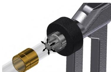
La operación de expansión debe repetirse al menos una vez más rotando la herramienta 30°. Si la parte interna del tubo no resulta perfectamente cilíndrica, repetir una vez más las operaciones descritas anteriormente.
