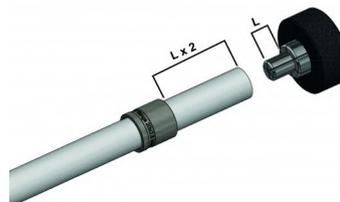
Ensanchar de manera gradual y homogénea el tubo sin recalentar las partes deformadas. Las temperaturas recomendadas para el ensanchado en frío están entre los -10°C a los 50°C.
