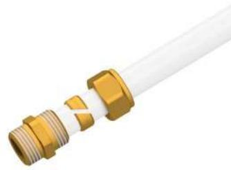
Das Rohr bis zum Anschlag einfügen und die Mutter so fest anziehen, wie es zulässig ist. Die Mutter mit dem Sechskantschlüssel so fest anziehen, bis das in der Tabelle angegebene maximale Drehmoment erreicht wurde (vorherige Seite).
