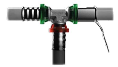
Il sistema LEAK BEFORE PRESS garantisce un'installazione veloce e sicura dei raccordi a pressare in quanto consente la fuoriuscita di liquido laddove la giunzione non sia stata pressata.
