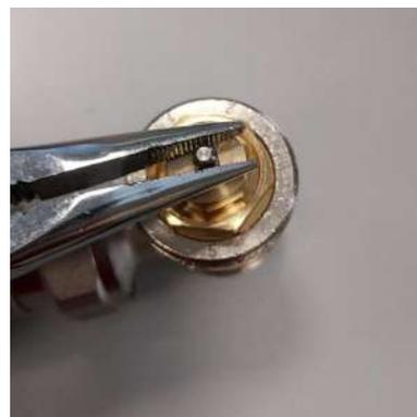
Die Ventile werden mit werkseitiger Voreinstellung in Position 6 geliefert.
