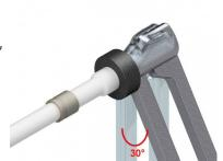
Отрежьте часть трубы, которая имеет неправильную форму после расширения, и выбросьте несоответствующий кусок трубы. Замените расширители, которые повреждены или не дают правильной формы расширяемой трубы. Неисправный расширитель может вызвать проблемы с уплотнением трубы и фитинга. Смажьте конус расширителя, если ход конуса затрулнен
