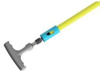
Calzar el tubo en el portatubo del racor hasta el tope de la arandela de plástico. El tubo ha sido correctamente insertado cuando se le puede ver a través de todos los orificios de control de la arandela de plástico
