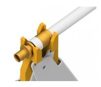
AUTOMATICA: Spingere la bussola verso il raccordo. Posizionare gli elementi nelle ganasce della macchina pressatrice, prestando attenzione che la bussola e il collarino del raccordo siano correttamente alloggiati in battuta alla ganascia.
