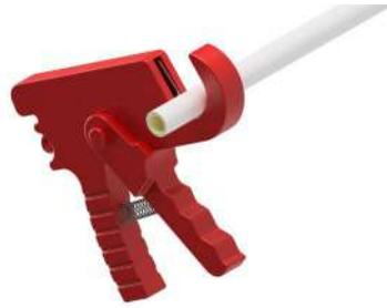
Calibrar y desbarbar el tubo con el calibrador indicado [código CS50.00; MA00.90], prestando atención a eliminar cualquier residuo posible. El borde interno debe estar completamente redondeado en toda la circunferencia del tubo.
