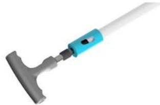
Calzar el tubo en el portatubo del racor hasta el tope de la arandela de plástico. El tubo ha sido correctamente insertado cuando se le puede ver a través de todos los orificios de control de la arandela de plástico.
