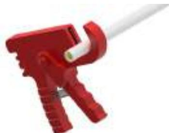
Откалибруйте трубу с помощью подходящей развёртки (код CS50.00, MA00.90), удалив оставшуюся стружку. Край трубы должен быть обрезан по всей окружности.
