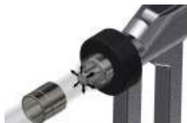
Примечание: в зависимости от типа трубы используйте соответствующий расширитель.
