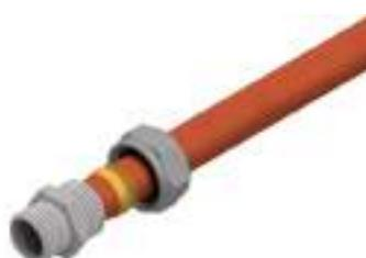
Вставьте трубу в корпус до упора и привинтите гайку вручную до упора.
