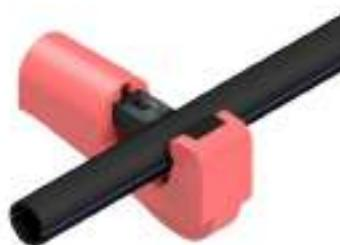
Установите компоненты на трубу в следующей последовательности: кольцевая гайка, открытое кольцо (отметки на наружной поверхности кольца должны быть расположены со стороны гайки, а не фитинга), компрессионное кольцо и прокладка (и, наконец, гильза где это предусмотрено).
