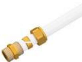
Вставьте трубу до упора и прикрутите вручную гайку до упора. С помощью шестигранного гаечного ключа завинтите гайку до указанного в Таблице числа оборотов (пред. страница).
