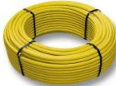
Многослойная труба характеризуется 5-слойной структурой, в которой алюминиевый слой, приваренный стыковой сваркой, заключен между двумя слоями сшитого полиэтилена (PEX) и прикреплен к ним двумя слоями клея.
