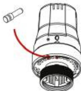
Вставьте второй штифт в тыльную часть, обозначенную соответствующим номером ограничения температуры (0-4).
