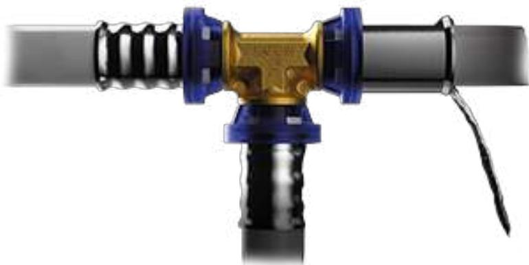
Система LBP обеспечивает быструю и безопасную установку пресс-фитингов, поскольку позволяет вытекание жидкости там, где соединение не было обжато.
