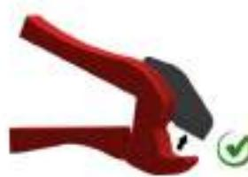
Отрежьте трубу перпендикулярно её оси с помощью подходящего труборезного инструмента (код TT500.00).
