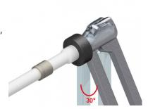
Tagliare i tubi che non presentano una circolarità regolare dopo l'espansione e scartare lo spezzone di tubo non conforme. Sostituire gli espansori che risultano danneggiati o non permettono la perfetta circolarità del tubo allargato. L'espansore difettoso può provocare problemi di tenuta nel tempo.
