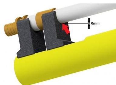
Veillez à ce que la douille et le raccord soient toujours insérés dans la bonne position.
