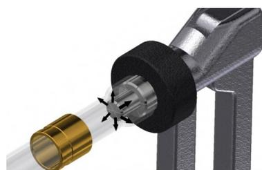
L'opération d'expansion doit être répétée au moins une deuxième fois en faisant pivoter l'équipement de 30°. Si l'intérieur du tube n'est pas parfaitement cylindrique, répétez les opérations décrites ci-dessus.
