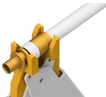
AUTOMATIQUE : Poussez la douille vers le raccord. Positionnez les éléments dans les mâchoires de la machine à sertir, en vous assurant que la douille et le collier du raccord sont correctement placés dans la mâchoire.
