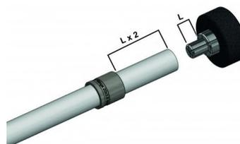
Agrandir le tube progressivement et uniformément sans chauffer les parties déformées. Les températures recommandées dans la phase d'évasement à froid peuvent varier de -10 °C à 50 °C. REMARQUE : selon le type de tube, utilisez l'ébaveur approprié.
