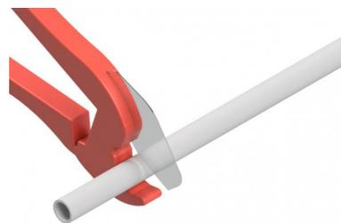
La coupe doit toujours être effectuée sur le côté droit du tube à une distance minimale de 150 mm du raccord précédent ou à une distance minimale de 20 mm de l'extrémité du rayon de courbure du tube. La coupe doit être propre, sans bavures à l'intérieur ou à l'extérieur du tube.
