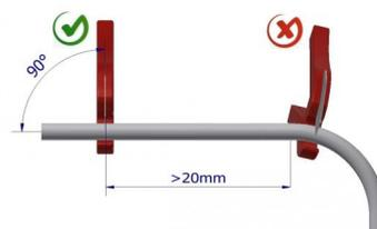
Vérifiez que l'expandeur n'est pas endommagé et qu'il se visse jusqu'à la butée. Une fois que l'expandeur est vissé, il ne doit pas se dévisser car le tube tourne sur l'expandeur. Vérifiez que l'outil utilisé est correct et défini pour le tube que nous allons assembler. Insérez l'expandeur sans forcer et parallèlement à l'axe du tube.
